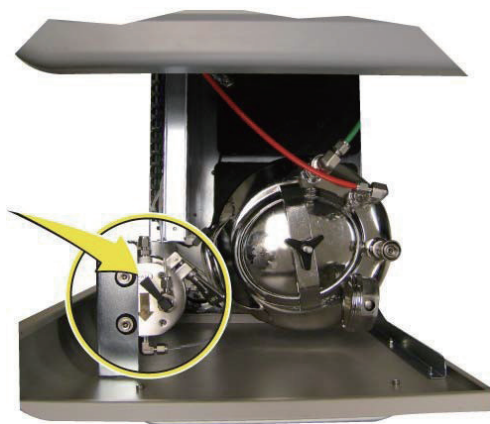
图 5.2 对鞘液过滤器进行排气泡处理
