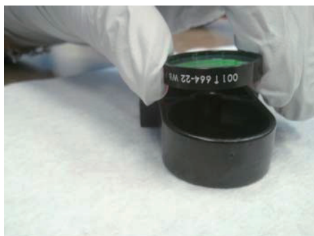
图 9.31 正确安装滤光片
